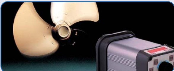
空调室外机风扇旋转状态检查
